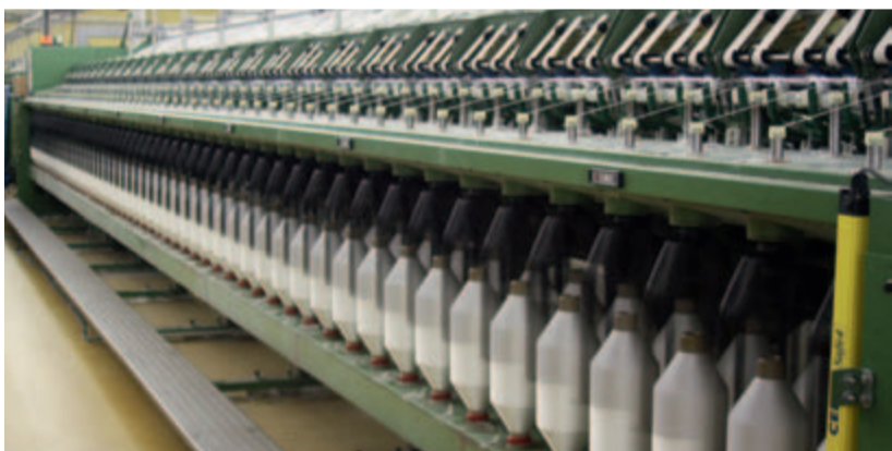
Ökologische und ökonomische Innovation bei der Bühler AG: Neue Air-Jet-Spinnmaschinen sorgen für hohe Produktivität und reduzieren den Energieverbrauch um bis zu 30%.
